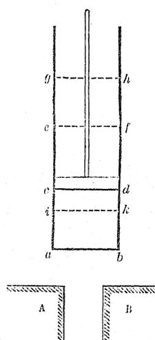
de l'air atmosphérique, par exemple, renfermé dans un vaisseau cylindrique *abcd* (*fig. 1*), muni d'un diaphragme mobile ou piston *cd*;
